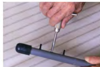
4.5mmの下穴に5mmのタップを切る
